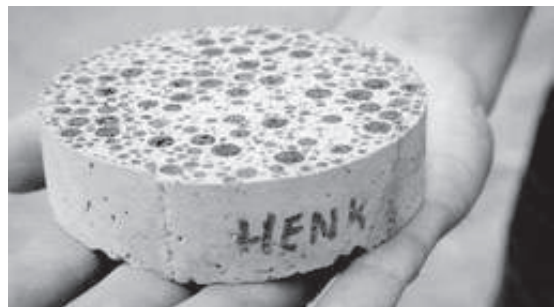
Hormigón autorreparable. Bio-concreto científico Henk Jonkers (Países Bajos)
